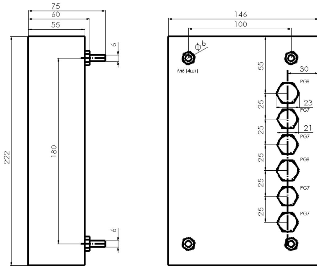
Для крепления блок оснащен шпильками М6 с длиной резьбовой части 15мм
