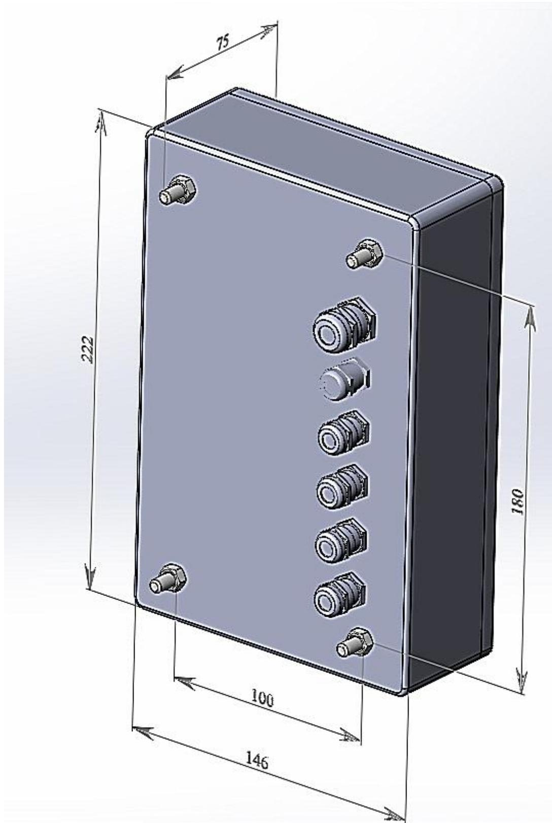
Для крепления блок оснащен шпильками М6 с длиной резьбовой части 10мм
